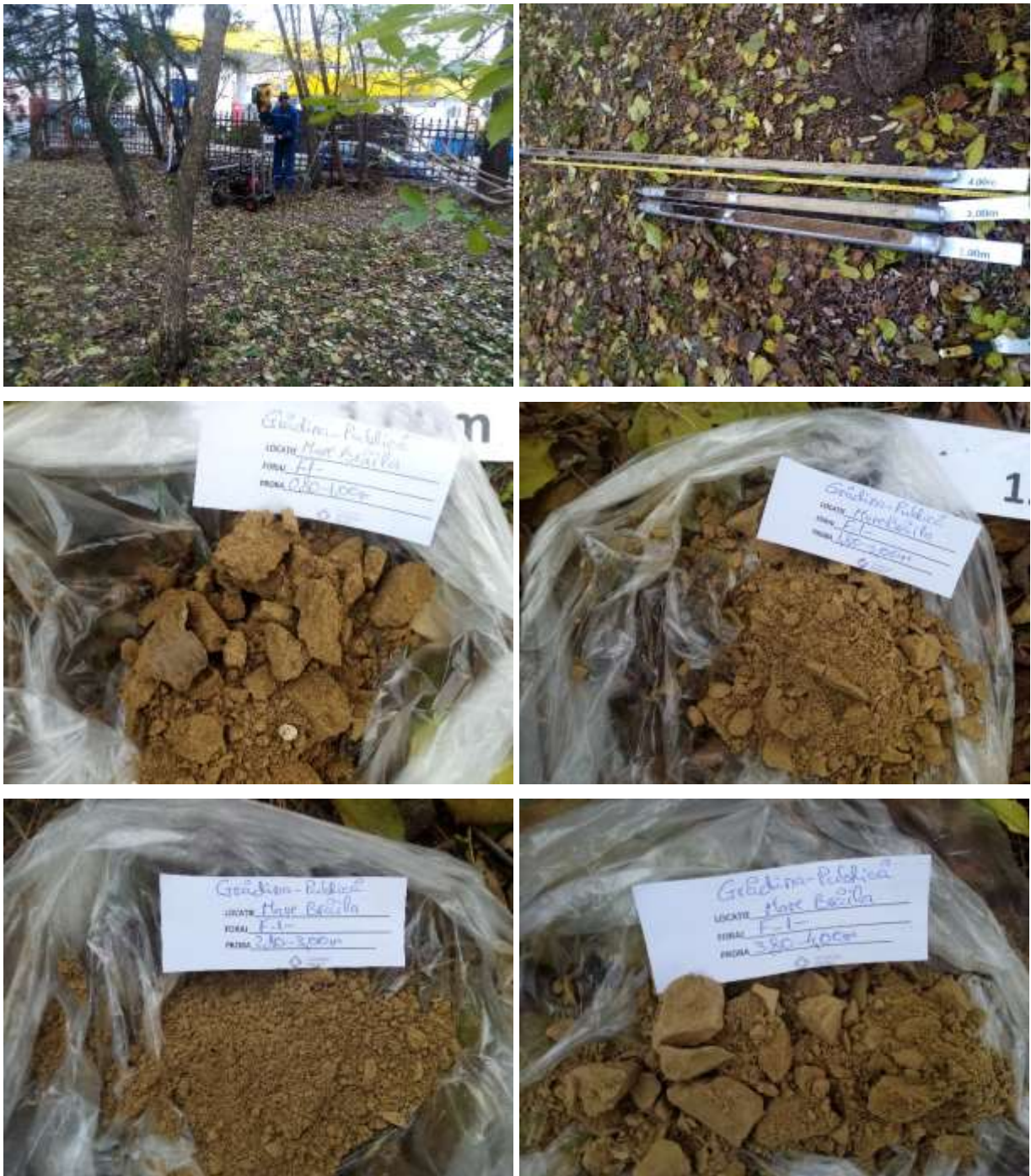
Fig. 15. Investigații geotehnice și prelevare probe
